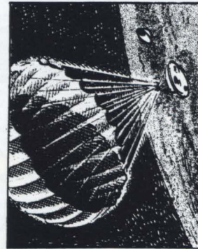
ALLT EFTER SOM LANDAREN NÄRMAR SIG MARS YTA, AVSKILJES HÖLJET OCH BRÖMSFALLSKÄRMEN MINSKAR HASTIGHETEN GENOM DEN TUNNA ATMOSFÄREN.
